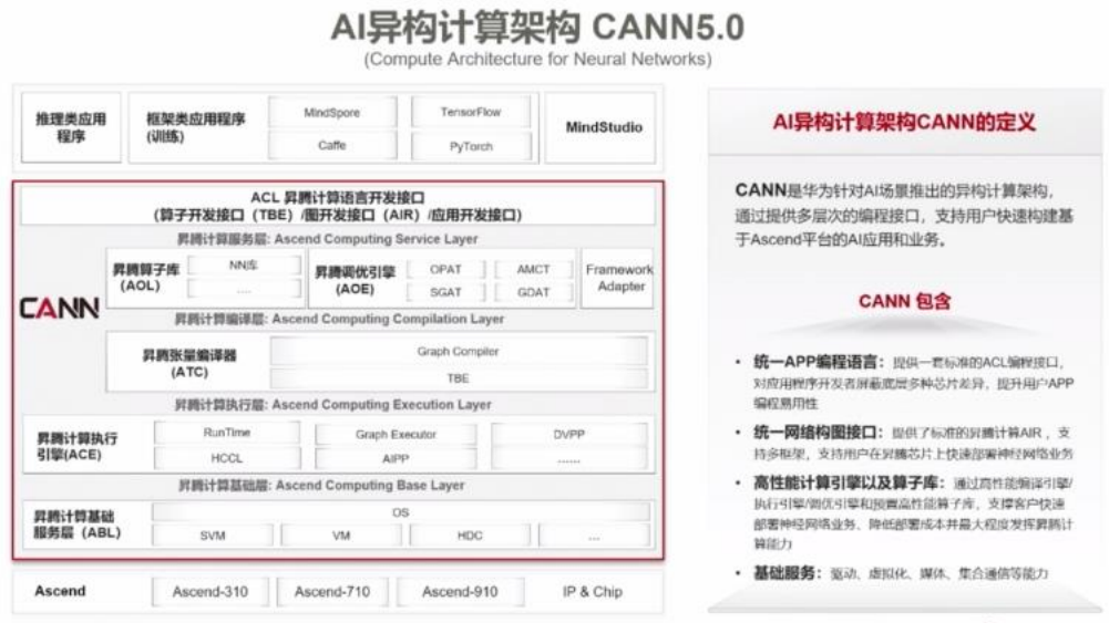
图38：华为 AI 异构计算架构 CANN
