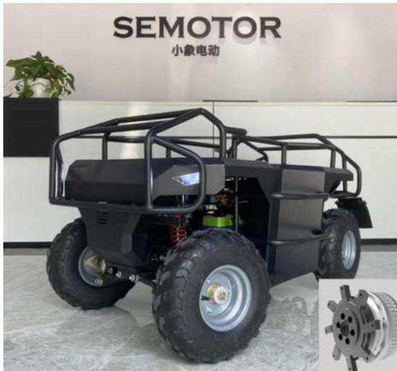
图表59: 电动汽车轮边电机系统
