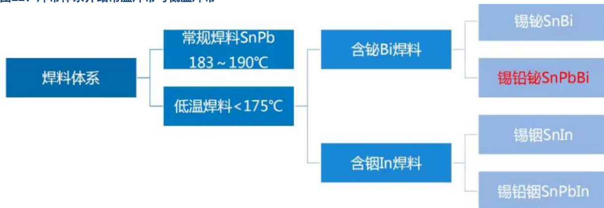
图22：焊带体系介绍常温焊带与低温焊带
