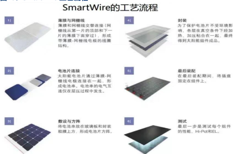
图16：SmartWire 工艺流程
