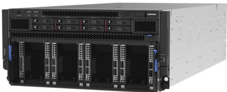
图42：ThinkSystem SR780a V3，搭载 NVIDIA GB200
