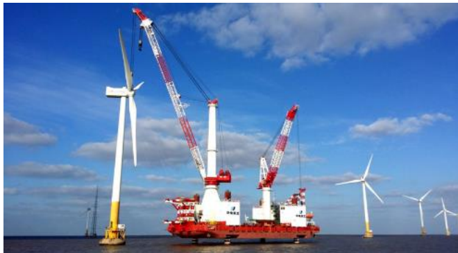
图表40: 华电 1001 号自升式海上作业平台
