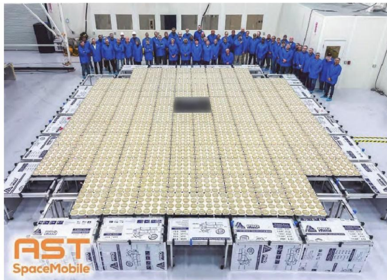
BlueWalker 3卫星的相控阵天线
