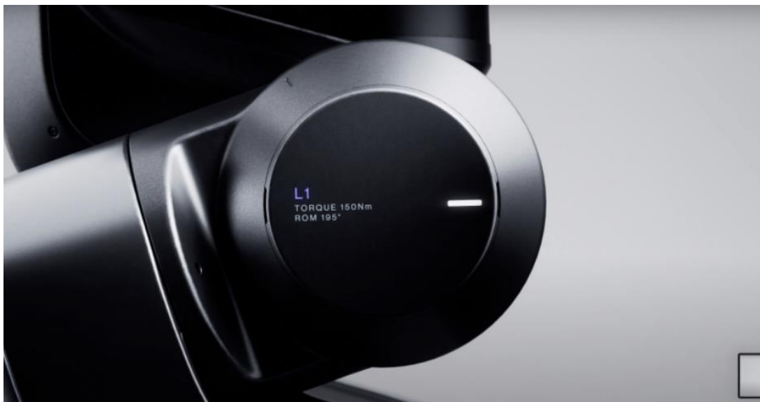
图表：Figure 02关节执行器最大扭矩150Nm，活动范围最高195度
