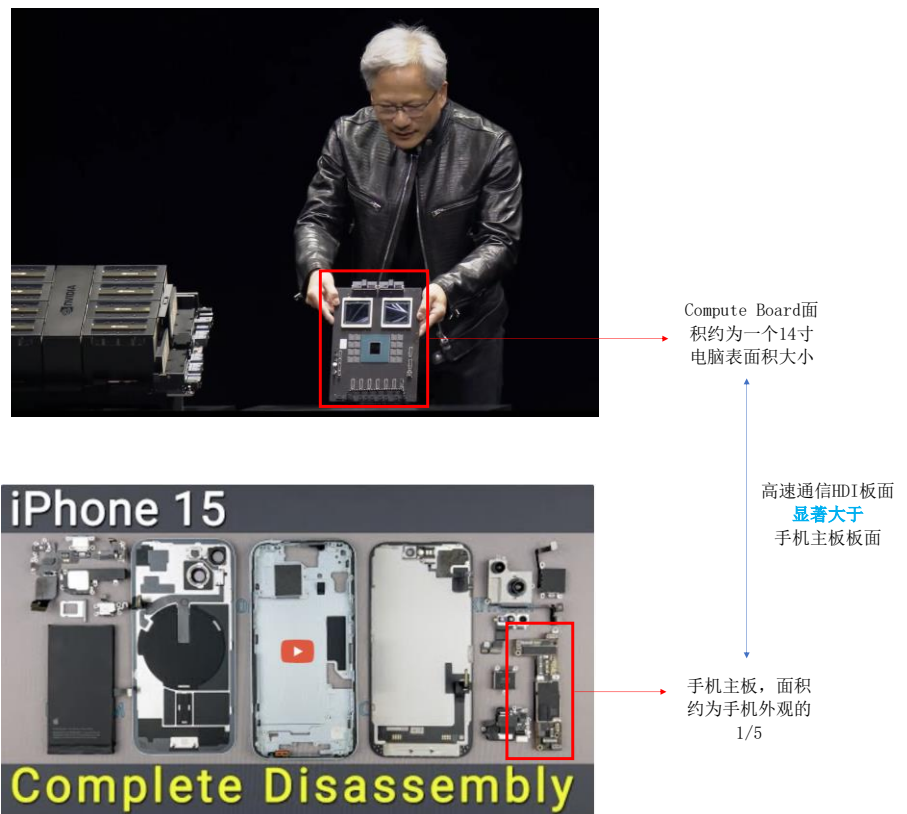
图表22: 高速通信领域所用 HDI 板与手机领域所用 HDI 板大小对比
