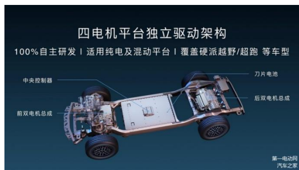
图21: 易四方四电机平台独立驱动架构
