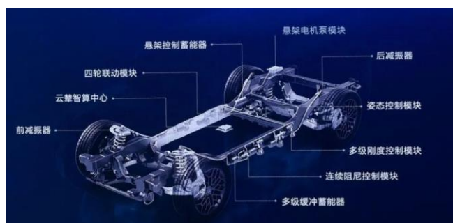
图18: 云辇-P 智能液压车身控制系统
