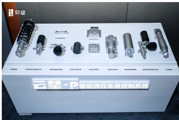
图17: 云辇-P 智能液压车身控制系统
