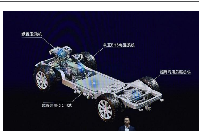
图24：DM-o 平台前纵置布局的 1.5/2.0T 发动机
