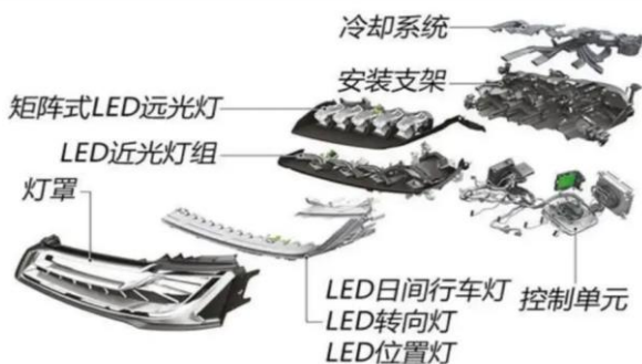
图 23：奥迪 A8 DLP 车灯结构
