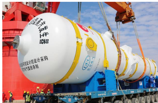
东方电气生产的华龙一号首堆蒸汽发生器
