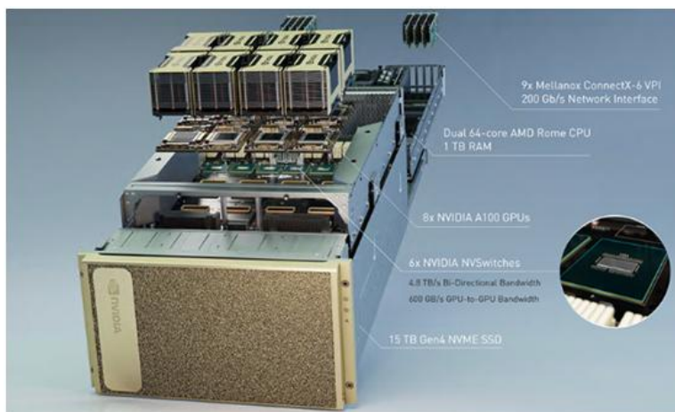
图 57： 英伟达 DGX A100 爆破图
