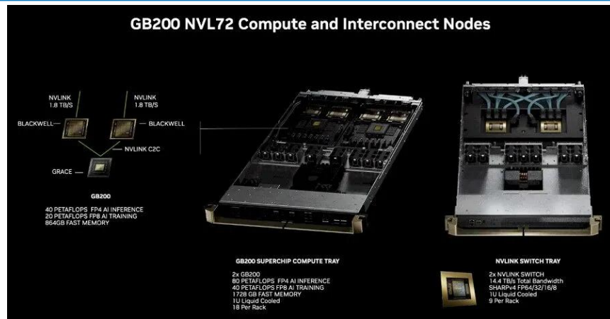
图 59：英伟达 GB200 NVL72 架构中 Compute Tray 的构成图
