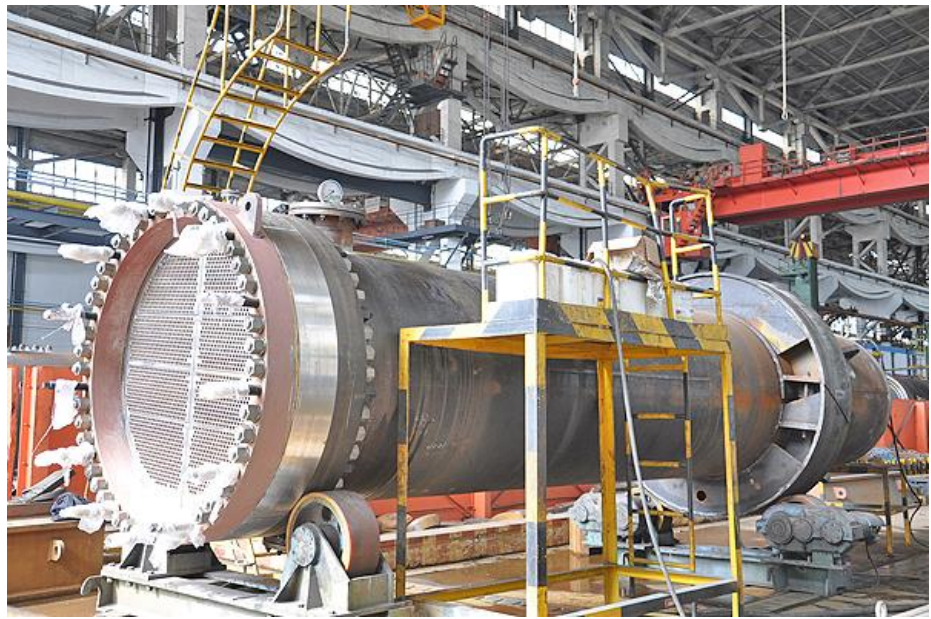
图8：2013年三门AP1000核电站1号机组正常余热排出热交换器即使用管壳式结构
