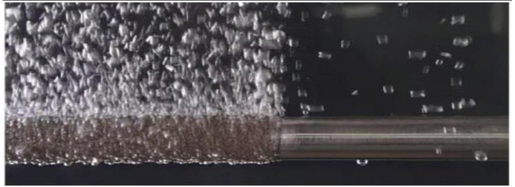
图3：高通量管能增强沸腾传热系数至普通光管的 3~8 倍，提升设备整体的传热效率
