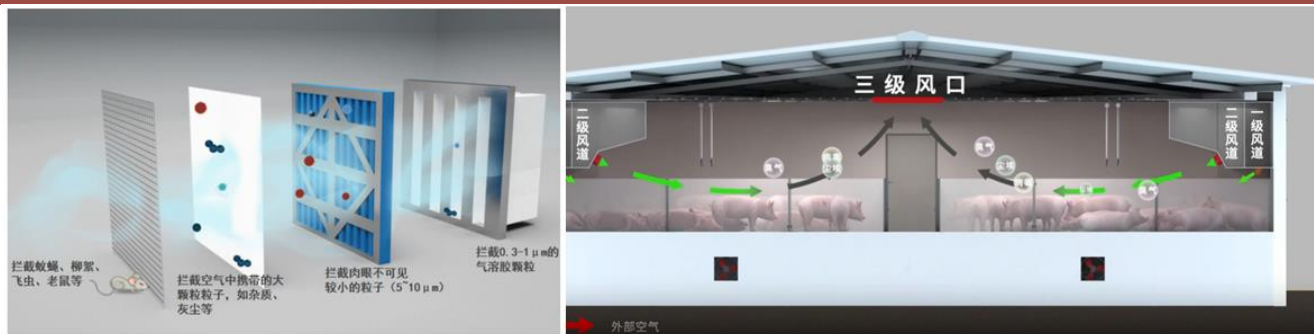
图44.公司猪舍空气过滤和精准通风功能
