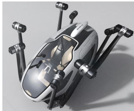
图5: EH216 机翼折叠收纳示意图
