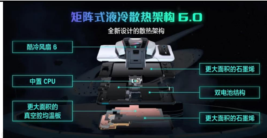
图 27：腾讯 ROG 游戏手机 6 系列矩阵式液冷散热架构示意图
