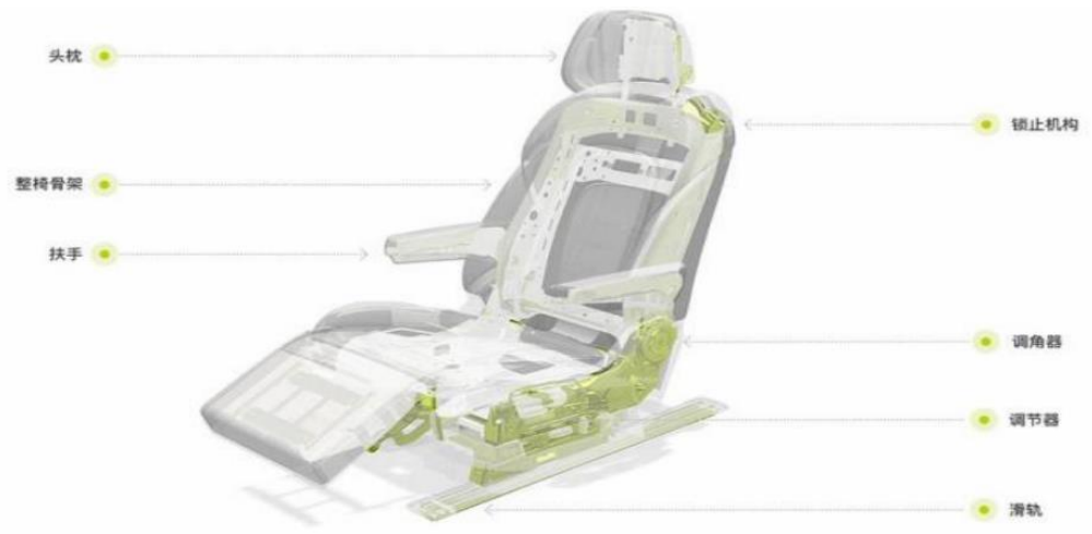
图14：汽车座椅主要由座椅骨架、滑轨、头枕、调角器等核心零部件组成
