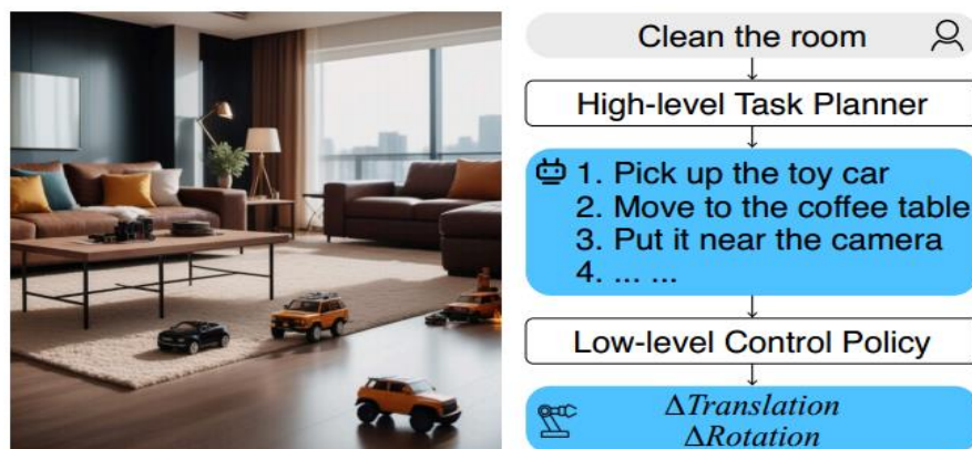
图28: 高级任务规划器和低级控制策略组成的分层机器人策略示意图
