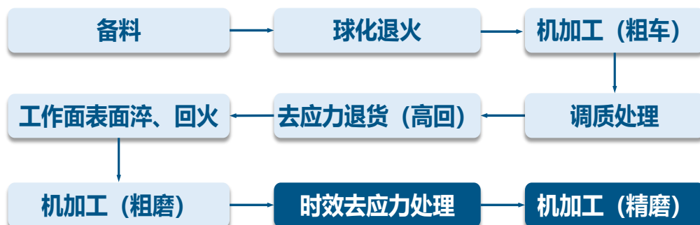
图表25：滚珠丝杠加工过程
