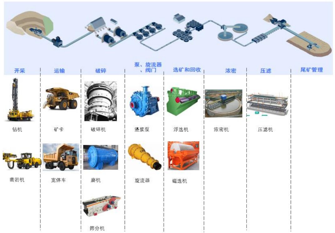
图表 42: 金属矿开采流程及设备
