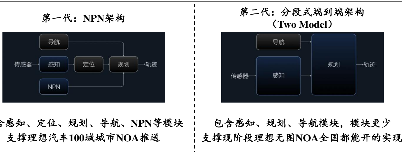
图23: 当前无图 NOA 的算法架构是分段式端到端
