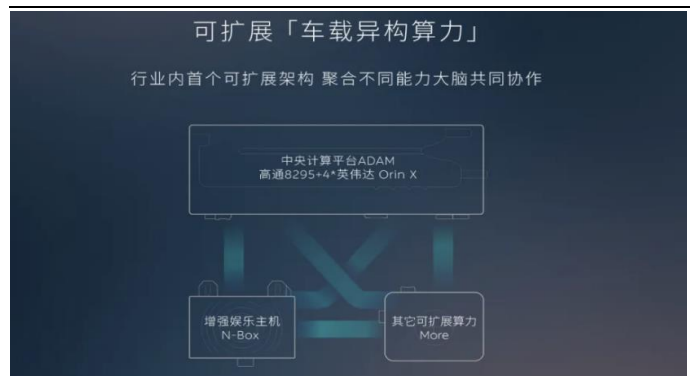
图51：支持实现智驾、智舱最大 256TOPS 算力共享
