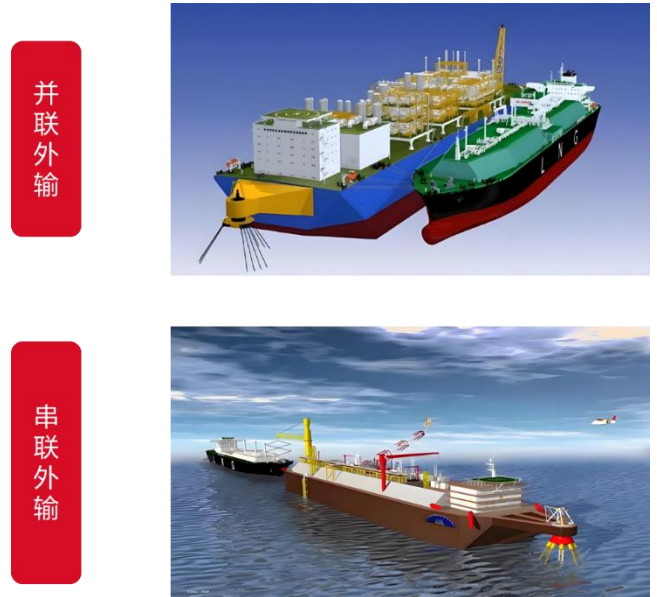
图22 FPSO 输油系统分类
