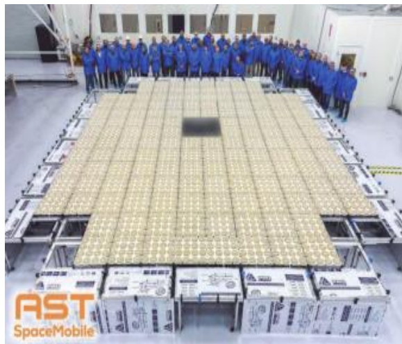
图表：相控阵天线折叠状态与展开状态
