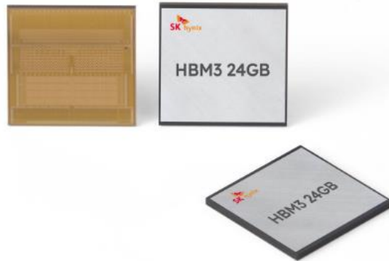
图1:SK Hynix 12 层 HBM3 产品提供 24GB 容量
