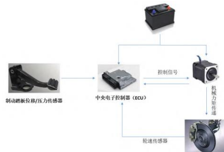
图表 51 EMB 电子机械制动系统主要组成部分及原理
