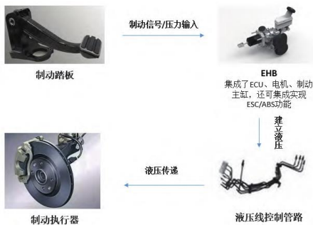
图表 50 EHB 液压线控制动系统工作原理
