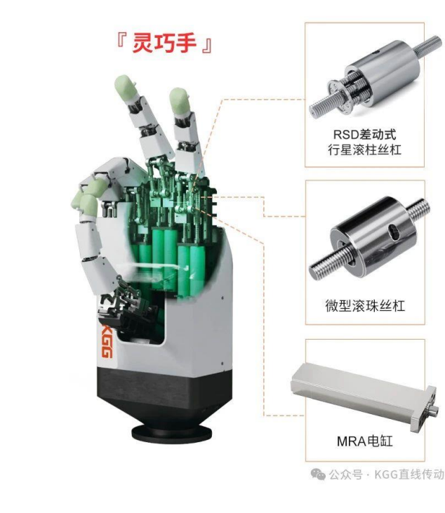
图表17: KGG 已经做出丝杠传动的灵巧手方案
