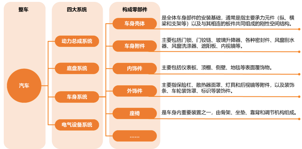
图 1：汽车组成结构
