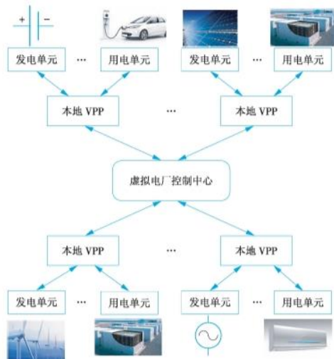
图表：虚拟电厂的集中-分散控制结构
