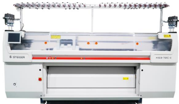
图18:KS3-72MC-I 全成型电脑横机
