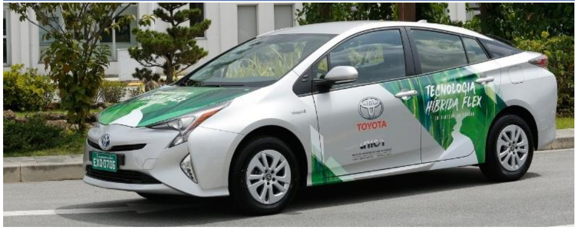
图15: 丰田在 2018 年 3 月发布了首款使用乙醇和汽油作为能源并搭载混合动力系统的产品
