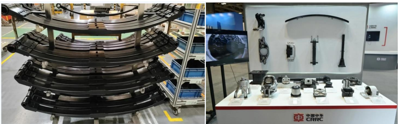
图 23：2024 年，公司轻量化单片式板簧量产，复合材料产品矩阵越来越完善
