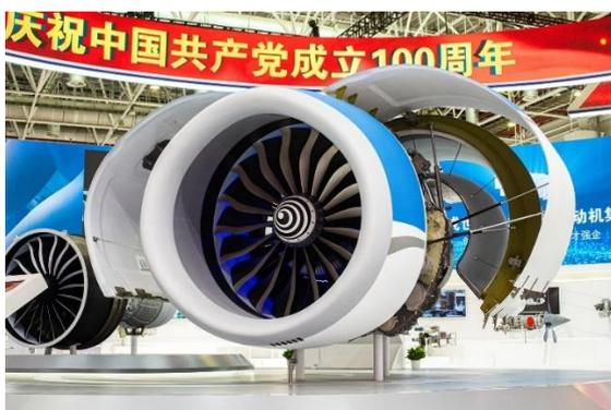
图表54: CJ1000A 发动机总体结构方案图
