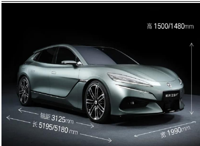
图76：腾势 Z9 GT 采用旅行车的车身结构设计
