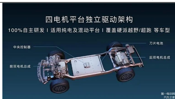
图6：易四方是国内首个量产的四电机驱动技术，能凭借四电机独立矢量控制技术对车辆四轮动态实现精准控制
