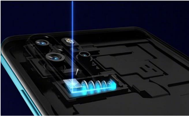
图24.华为 P30 系列潜望式镜头原理图
