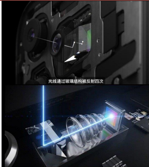
图27.四反潜望式长焦（上）与单反潜望式长焦（下）结构图
