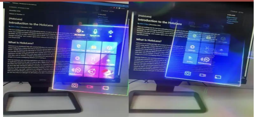
图17.衍射光波导（左）与反射光波导（右）成像效果
