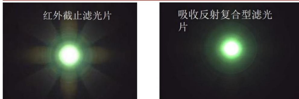
图34.涂覆技术带来滤光片更优成像效果
