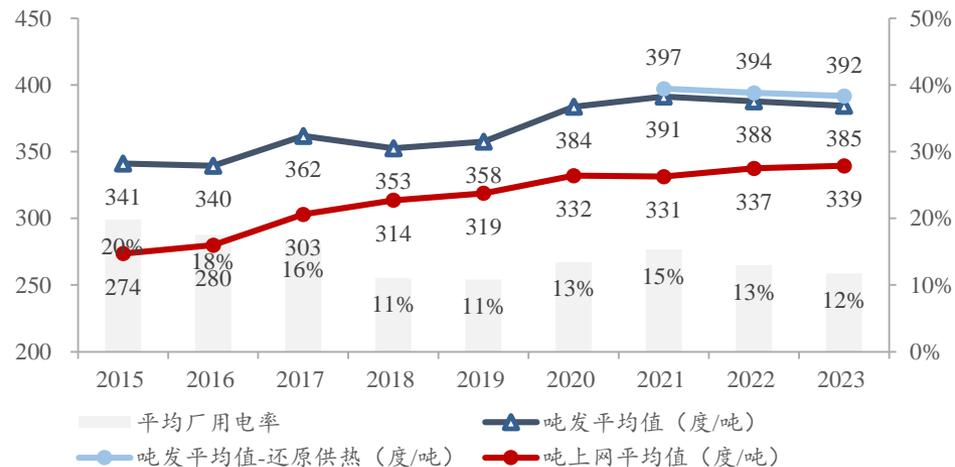
图：垃圾焚烧上市企业吨发电量 (度/吨)
