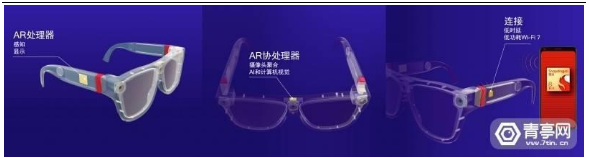
图表 17. 高通 AR2 芯片的分布式架构及布局位置参考
