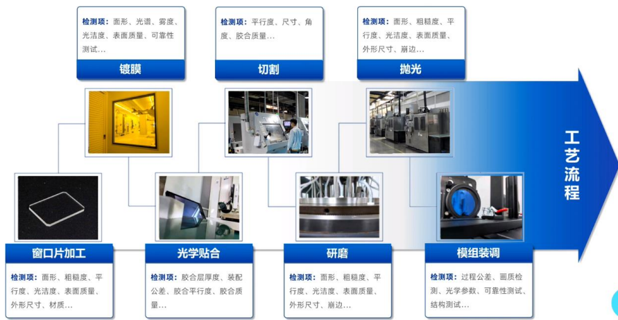
图表 32. 几何波导生产工艺示意图（灵犀微光）
