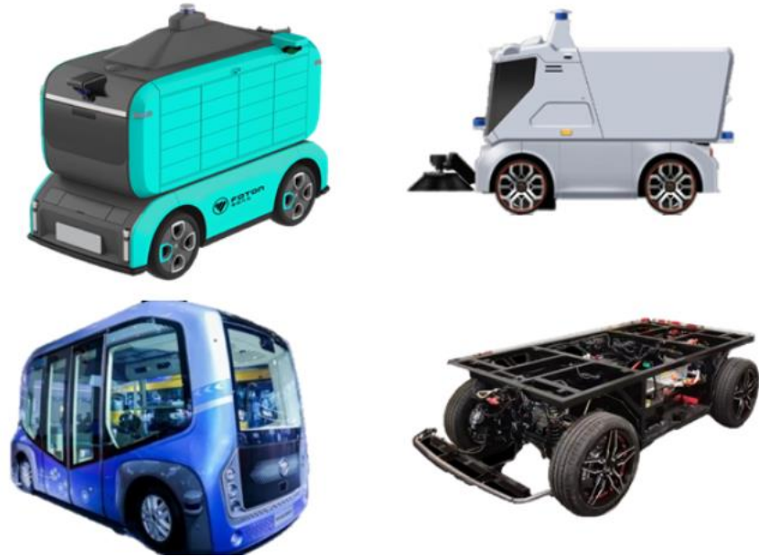
图表 80 公司无人配送车、无人环卫车、MiniBus，无人装备标准化线控底盘产品
