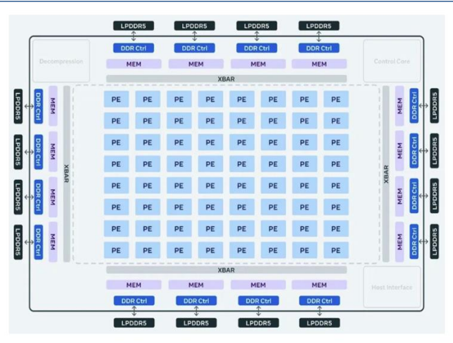
图表103： MTIA V2 芯片采用 8x8 处理元件 (PE) 布局
