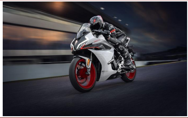
图43.450SR 外观增加定风翼设计，提高车辆稳定性
