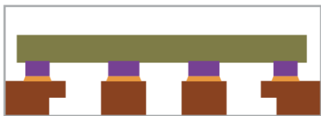
图1：HotRod 互连封装(引线框上倒装芯片)QFN 封装
