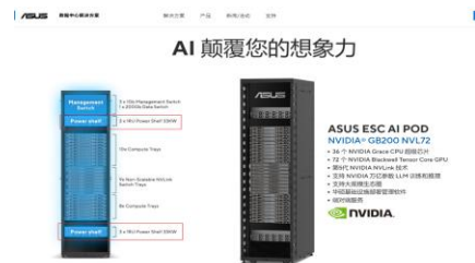
图：AINVIDIA GB200 NVL72机柜电源（最上方和最下方是电源模块区域）
