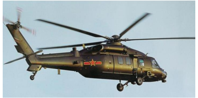
图表21：我国新一代武装直升机已应用 T800 复材，用量超 50%
