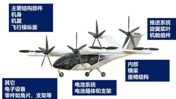
图表42：eVTOL 用复合材料主要部位
