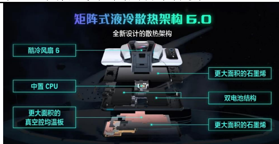
图 30：腾讯 ROG 游戏手机 6 系列矩阵式液冷散热架构示意图
