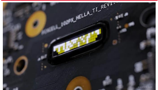
图18 海拉 SSL 100 前照灯内部的 LED 矩阵芯片
