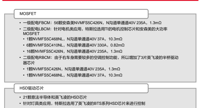
图45 Model 3 车身控制模块配电方案
