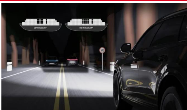
图17 海拉 SSL 100 前照灯的防眩目效果
