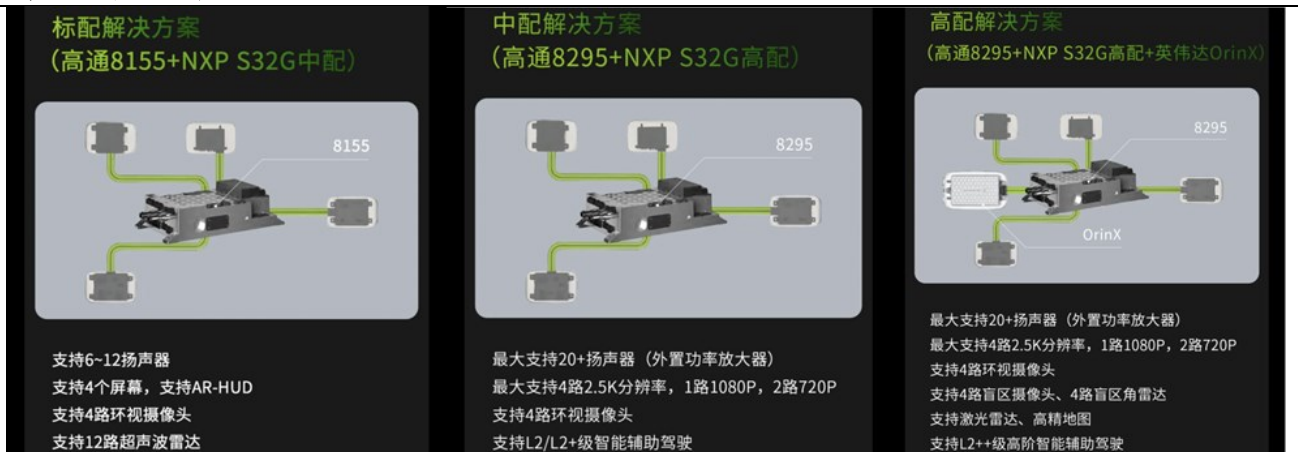
图18:零跑汽车四叶草架构
