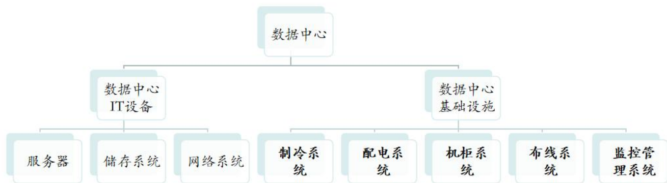
图 3、数据中心基础设施构成
