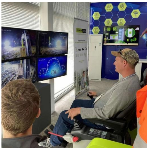
图表60: 借力 5G 全球最远距离远程操控挖掘机
