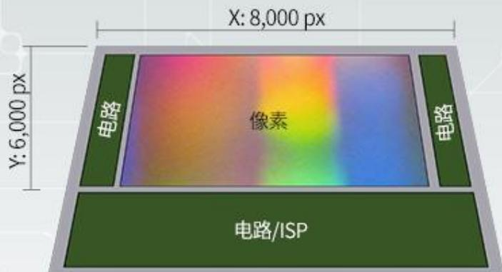
如果将超精细逻辑制程应用于下基板电路，复杂的ISP算法可通过低功耗、高集成度的数字电路来实现。尽管由于电路面积的限制，传统传感器的ISP仅支持镜头校正和缺陷校正等简单的功能，但是堆栈传感器的ISP可利用超精细逻辑制程来实现创新的算法，例如图像处理，计算机视觉以及人工智能等。
