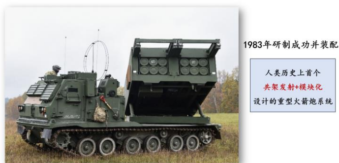
图表17: M270 是历史首个共架模块化的重型火箭炮系统
