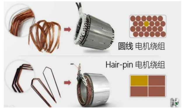
图 36：扁线绕组可以提升槽满率
