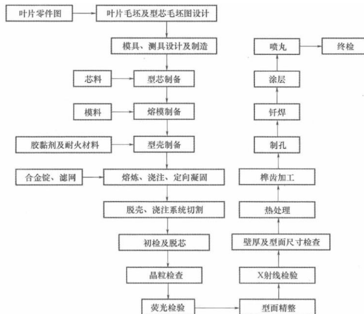
图43 涡轮叶片制备工艺流程
