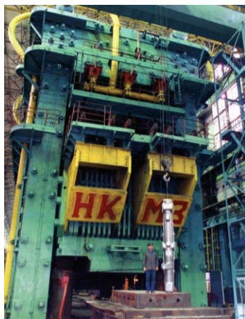
图18 乌克兰新克拉马托重型机器厂(HKM3)建造的 7.5 万吨级模锻液压机
