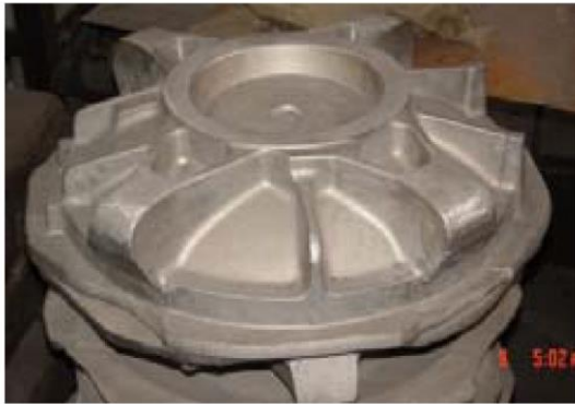
图25 镁合金机匣等温精密锻件
