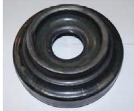
图26 钛合金叶栅环等温精密锻件
